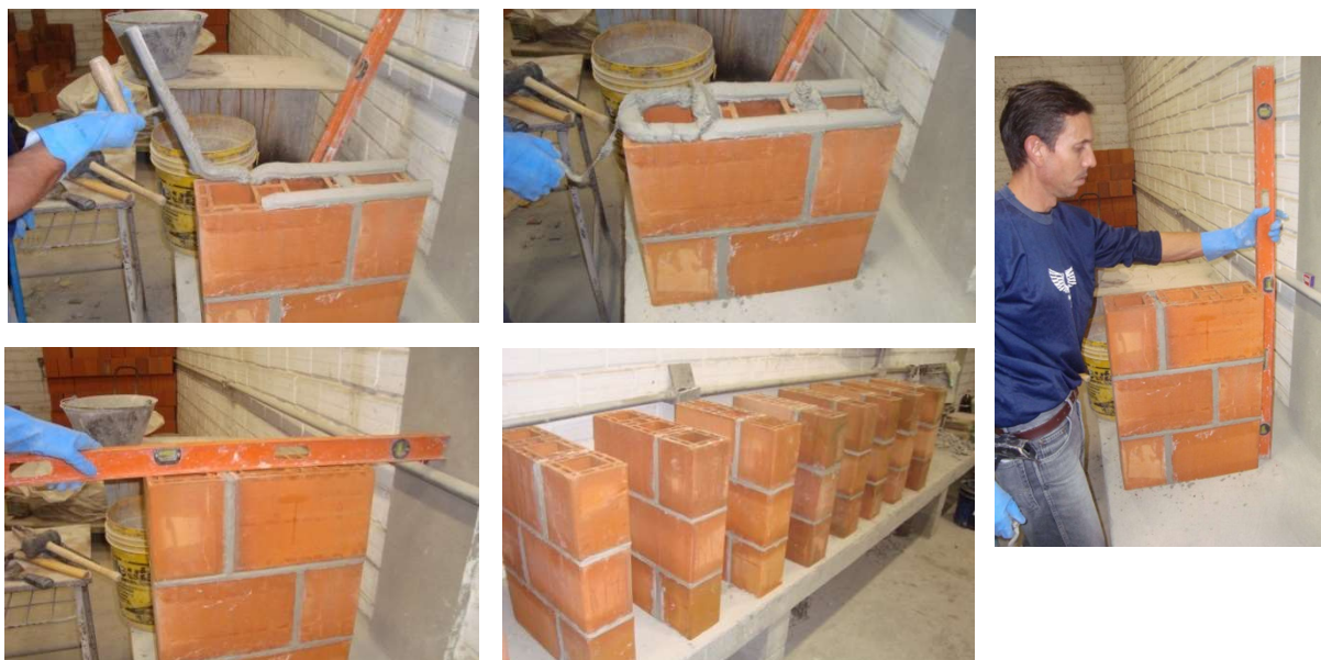
Figura 3.6 – Moldagem dos Prismas.
