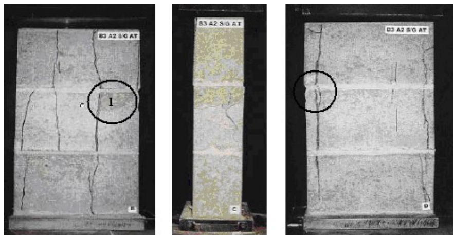
Figura 2.11 – Modo de ruptura dos prismas de blocos de concreto não-grauteados (a região 1 é mostrada no prisma da esquerda)
