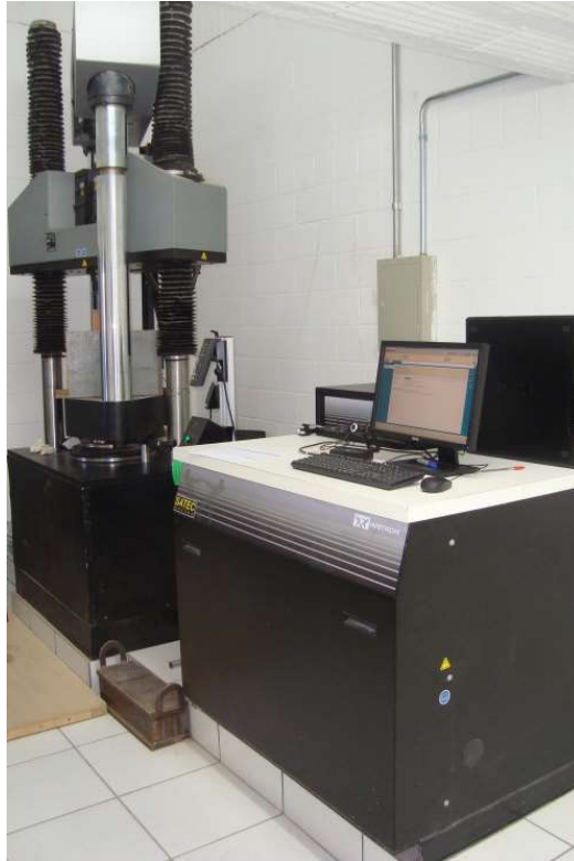
Figura 3.9 – Prensa Instron Estrutura 1500HDX – Utilizada no experimento.
