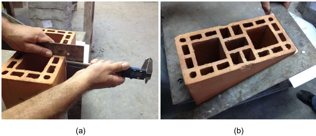
Figura 3.2 – Ensaio Dimensionais: (a) Desvio em relação ao esquadro, (b) Planeza das faces.
