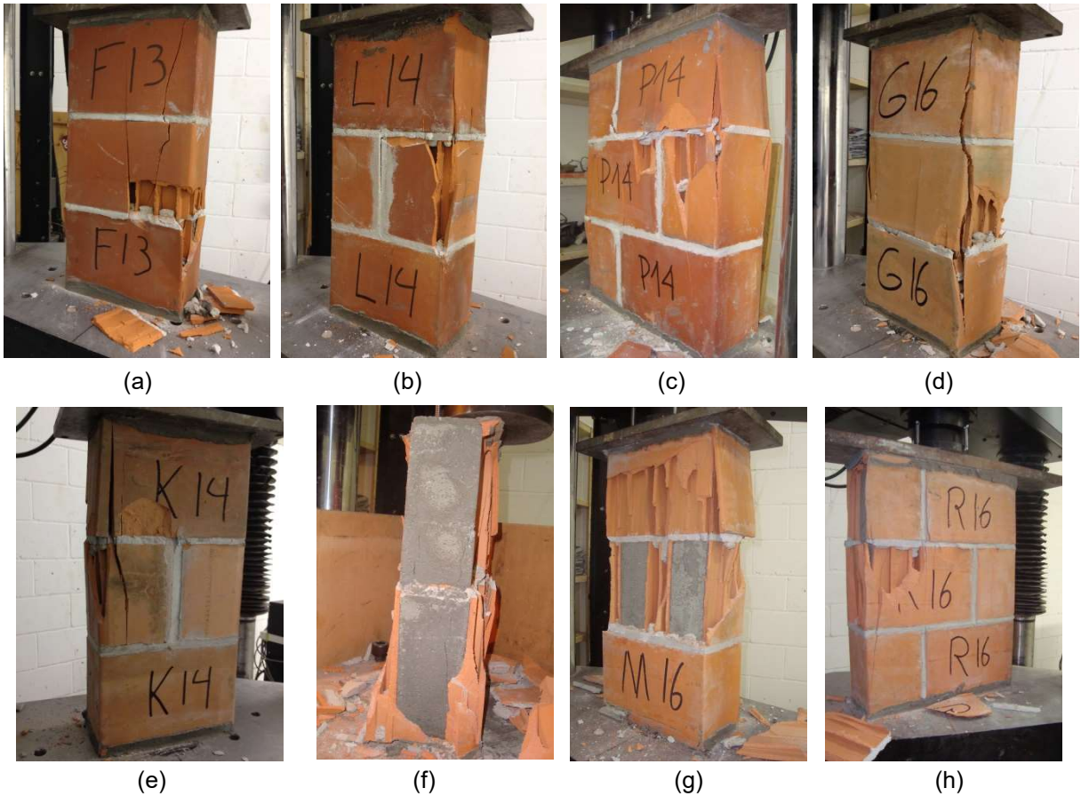
Figura 3.14 – Modo de ruptura semelhante para os prismas grauteados - Fabricante 1 f_{bk(A)} 6,0 MPa: (a) Modelo 2, (b) Modelo 3, (c) Modelo 4. Fabricante 2 f_{bk(E)} 7,0 MPa: (d) Modelo 2, (e) Modelo 3. Fabricante 3 f_{bk(B)} 6,0 MPa: (f) Modelo 1, (g) Modelo 3, (h) Modelo 4.
