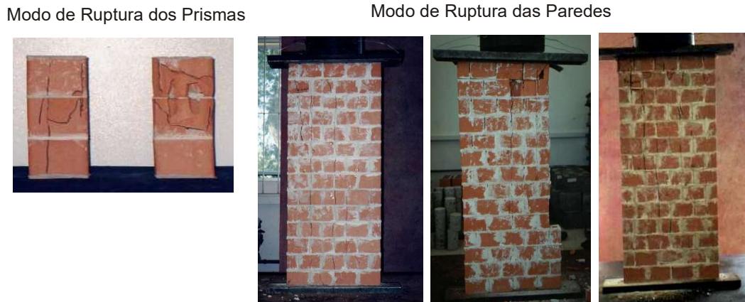
Figura 2.18 – Modo de ruptura dos prismas e paredes de alvenarias cerâmicas
