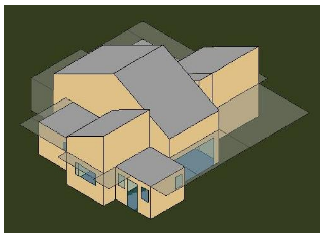
Figura 44 – Modelo analítico de energia da Casa Eficiente a partir de massas conceituais
