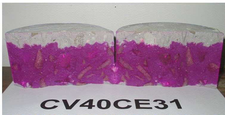
Figura 35 –Corpo-de-prova após aspersão de fenolftaleína
