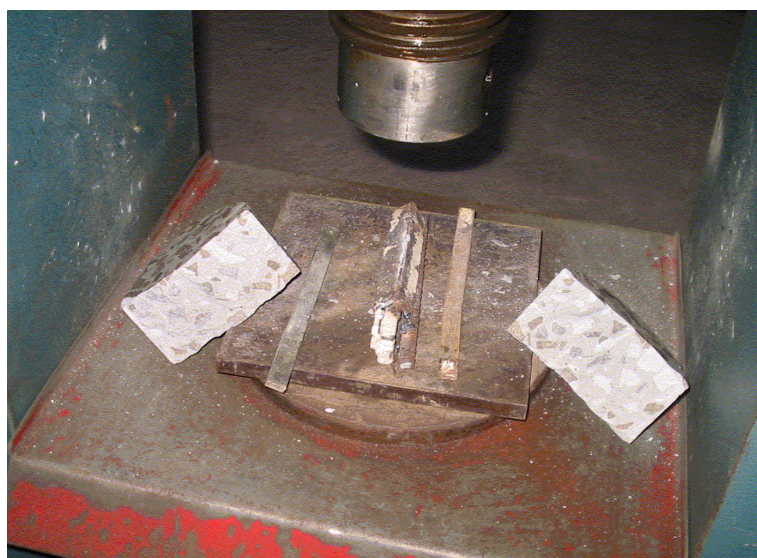
Figura 34 – Ruptura dos corpos-de-prova
