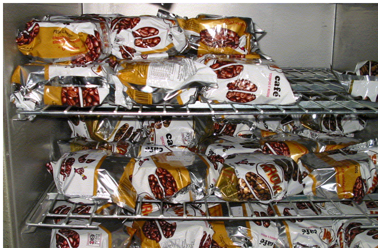
Figura 30 - Estufa a 50°C para redistribuição da umidade
