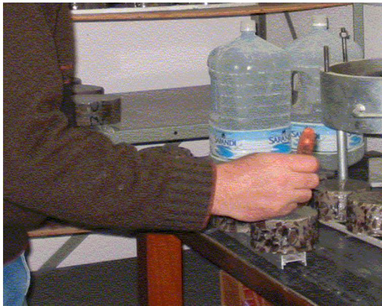
Figura 25 – Aplicação de verniz na lateral e na face inferior
