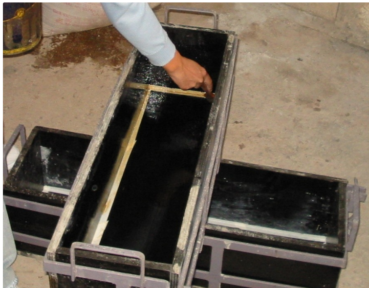
Figura 17 – Preparação das formas para moldagem
