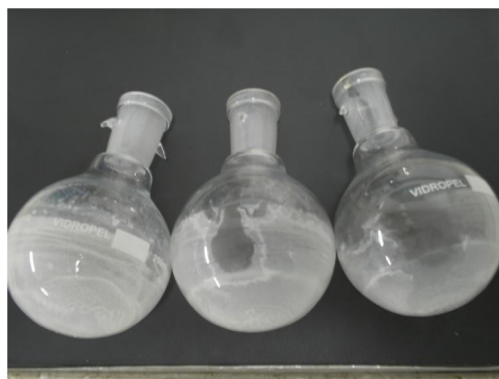
Figura 18 - Resíduos do Processo de Destilação, na Sequência para Temperaturas de 100, 80 e 70°C, respectivamente da Esquerda para Direita.
