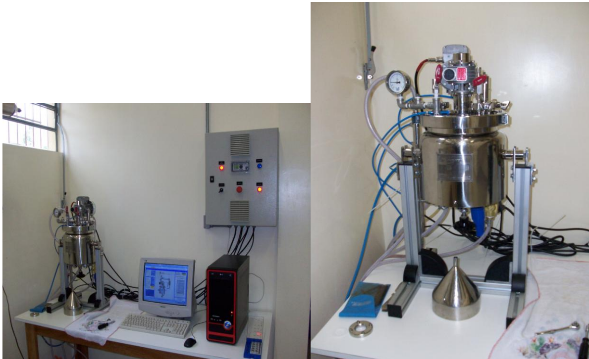
Figura 7 - Reator utilizado para o processo de hidrólise.
