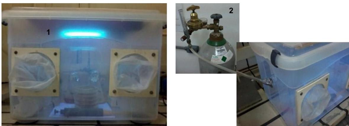
Figura 10 – Caixa-de-luvas empregada na manipulação do micro-organismo: 1) lâmpada germicida; 2) fluxo de  $\text{N}_2$ .
