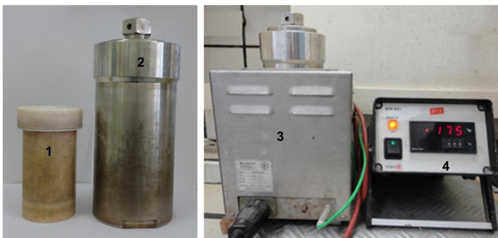
Figura 9 – Sistema Berghof empregado na hidrólise ácida da casca de arroz. Componentes: 1) vaso de teflon; 2) morteiro de aço inox; 3) sistema de aquecimento/resfriamento; 4) controlador de temperatura.
