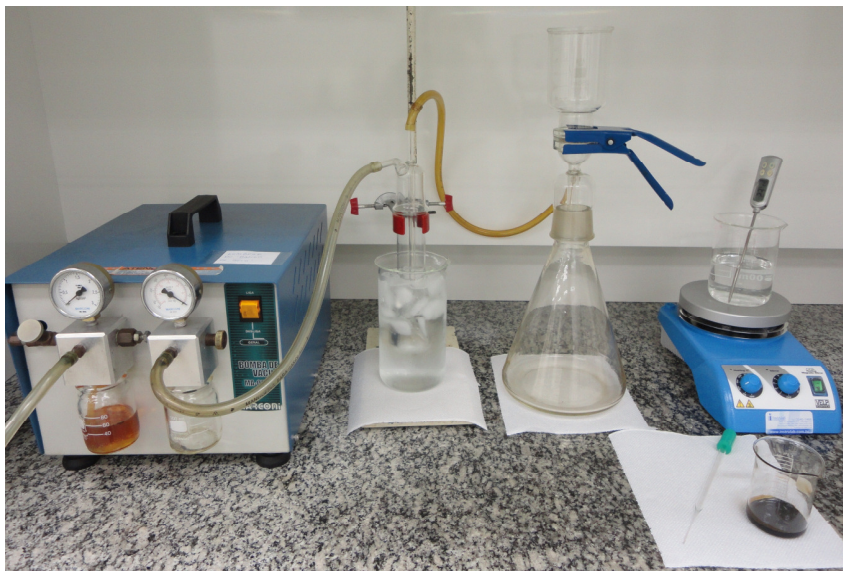
Figura 12. Sistema utilizado para a filtração dos sedimentos das amostras de petróleo.
