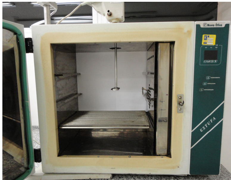
Figura 9. Estufa equipada com agitador mecânico para homogeneização e aquecimento simultâneo das amostras.
