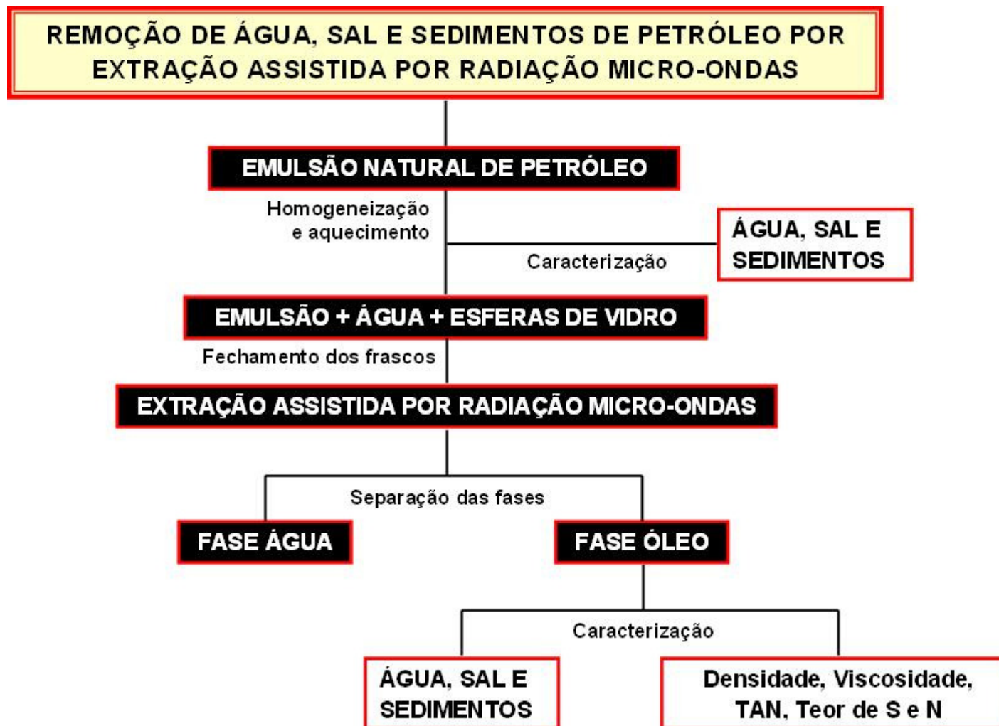
Figura 14. Etapas envolvidas para a remoção de água, sais e sedimentos de amostras de petróleo utilizando radiação micro-ondas e caracterização das amostras.
