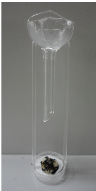
Figura 11. Suporte de quartzo, contendo a amostra de petróleo sobre o papel filtro, utilizado para a decomposição por MIC.
