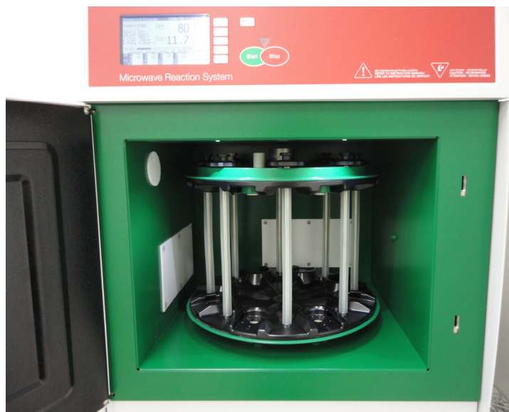
Figura 10. Forno de micro-ondas e rotor utilizados para o procedimento de remoção de água, sal e sedimentos de emulsões de petróleo.
