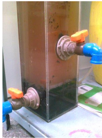
Figura 7 – Início da Formação do Lodo
