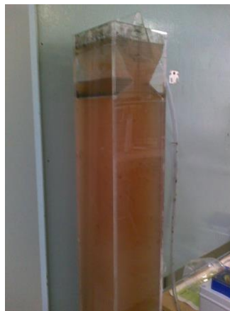
Figura 8 - Enchimento até os vertedores
