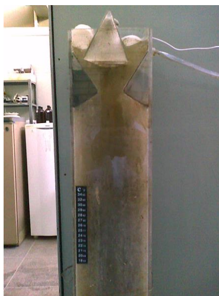
Figura 9 - Formação de espuma
