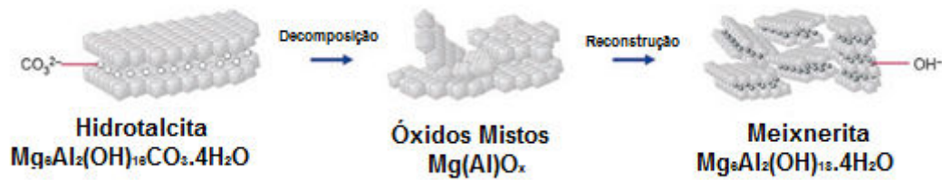
Figura 2.15 – Decomposição e reconstrução de materiais do tipo hidrotalcita (PEREZ-RAMIREZ et al. , 2007).
