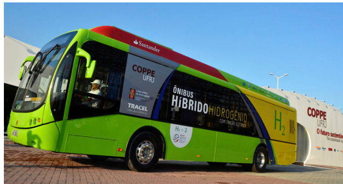
Figura 2.3 – Ônibus movido a hidrogênio desenvolvido no Brasil (PLANETA COPPE, 2012).
