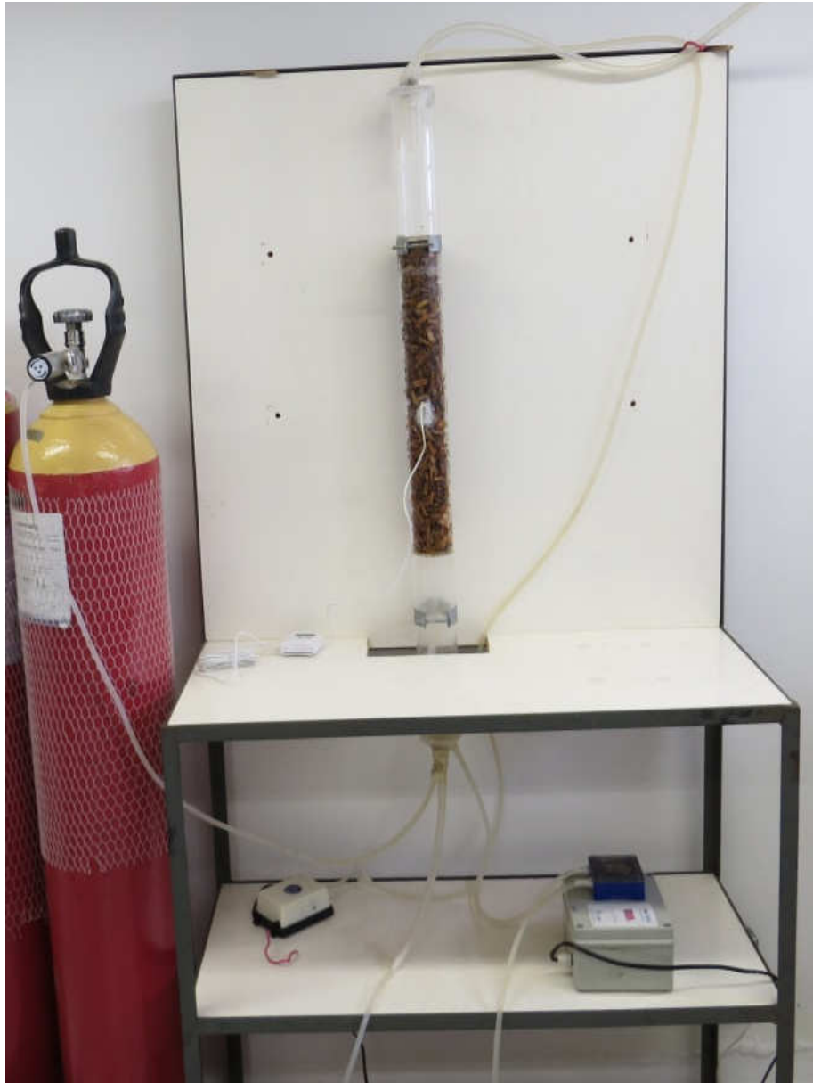
Figura 7 – Visão geral do sistema de biofiltração
