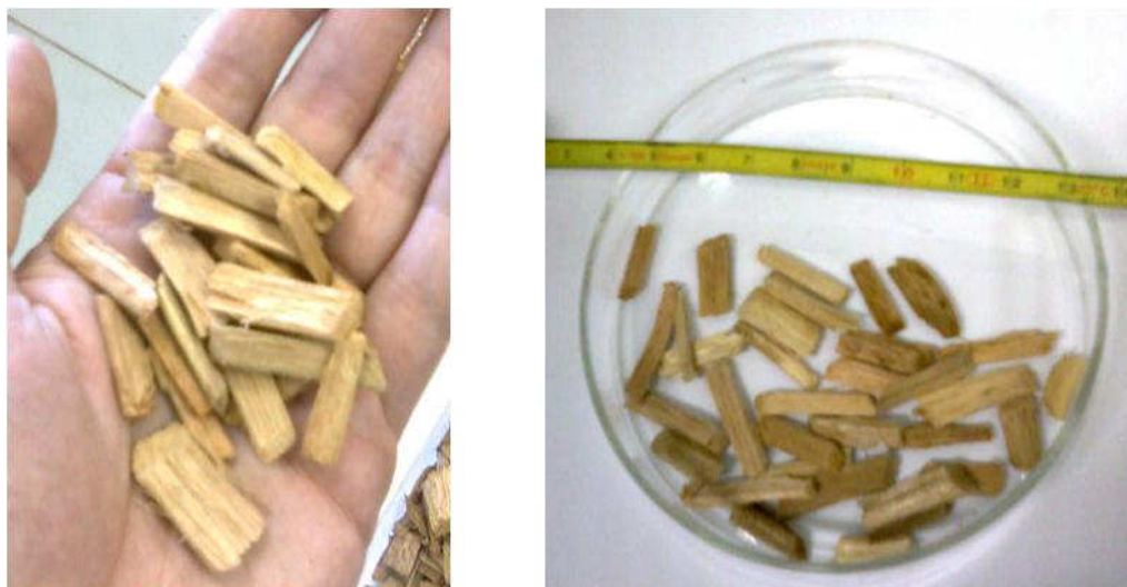
Figura 9 – Amostras de cavacos de madeira utilizadas como material suporte do biofiltro
