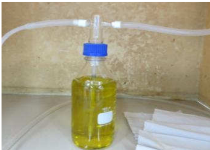
Figura 12 – Sistema de captura do H 2 S da fase gasosa
