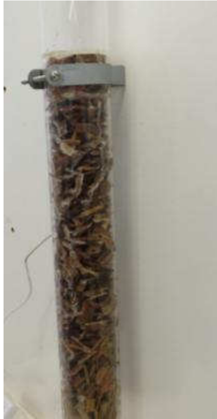
Figura 11 – Material suporte inoculado com microrganismos, usado no leito da coluna de biofiltração
