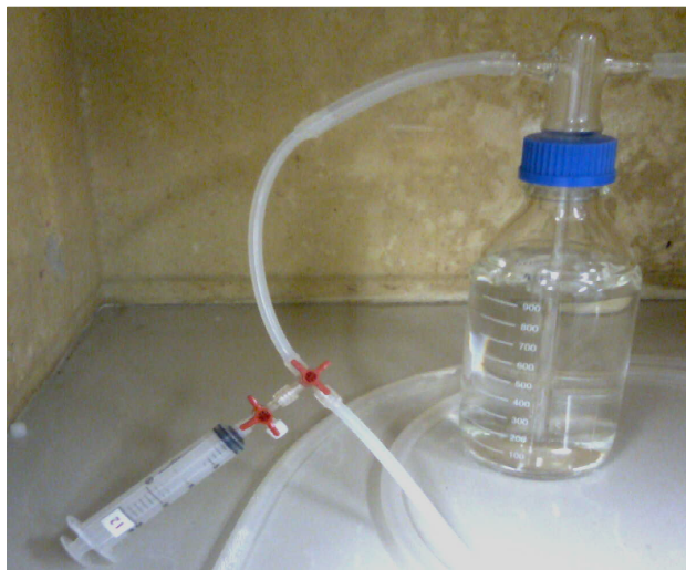
Figura 14 – Sistema de coleta de amostras de biogás sintético para análises de \text{CH}_4 e \text{CO}_2
