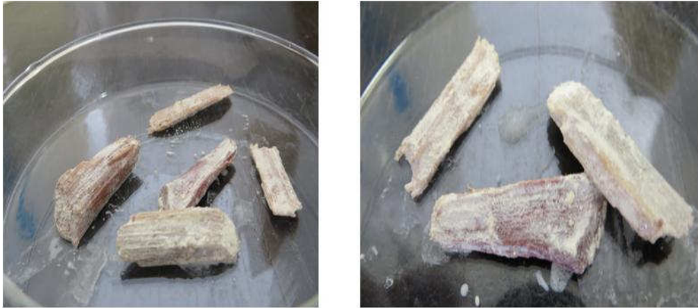
Figura 25 – Material suporte retirado do biofiltro após o término da operação
