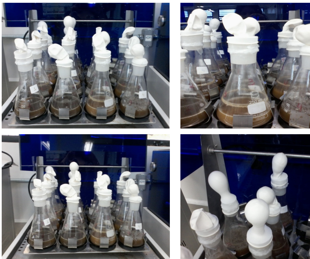
Figura B2: Aparato utilizado para a produção anaeróbica de biobutanol.
