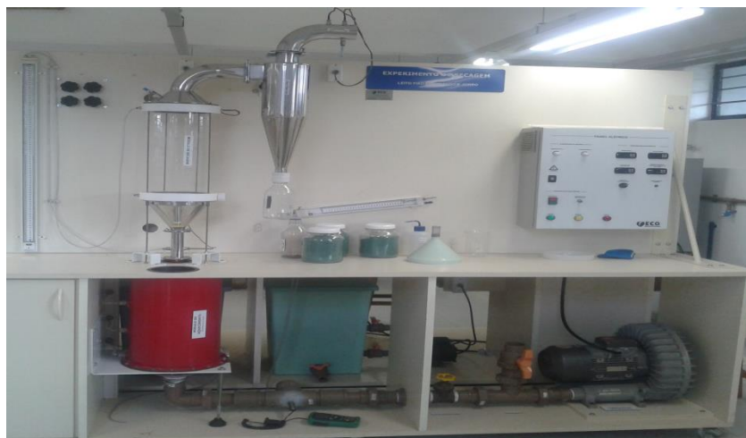
Figura 19 - Unidade experimental de leito de jorro. Fonte: Autor (2014).
