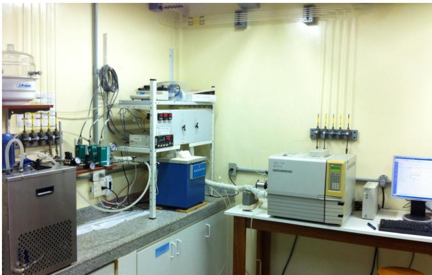
Figura 23 - Foto da unidade reacional utilizada para os testes catalíticos.
