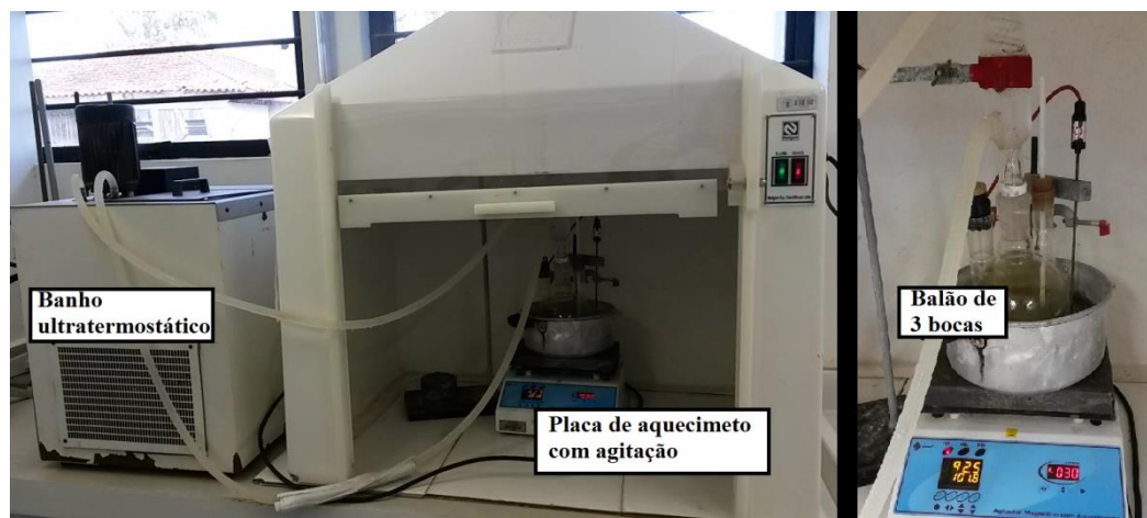
Figura 13 - Sistema utilizado para o processo de lixiviação.
