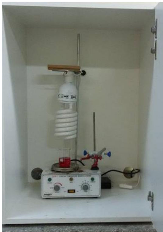
Figura 5 – Estrutura utilizada nos ensaios de foto-Fenton.
