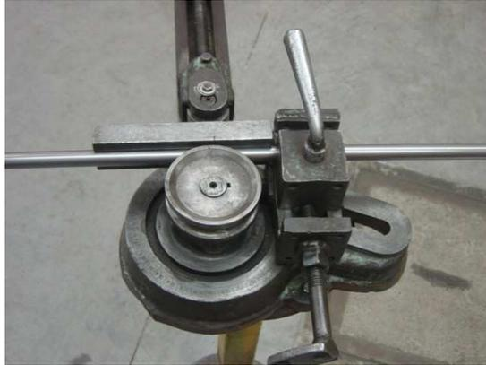
Figura 3.12 - Tubo preso na morsa da dobradeira manual
