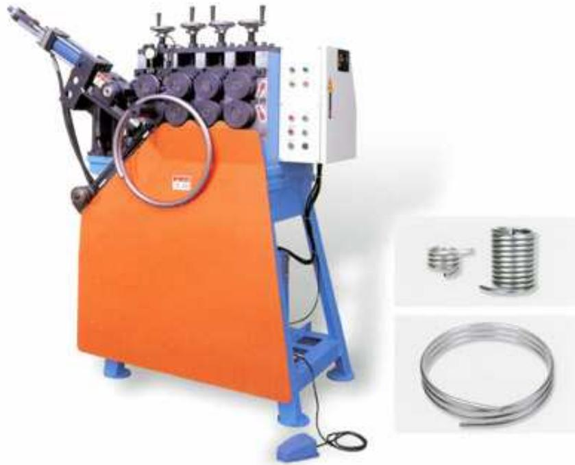
Figura 2.28 – Calandra de tubos e perfis motorizada e vertical. Fonte: SHUZ TUNG, 2008.
