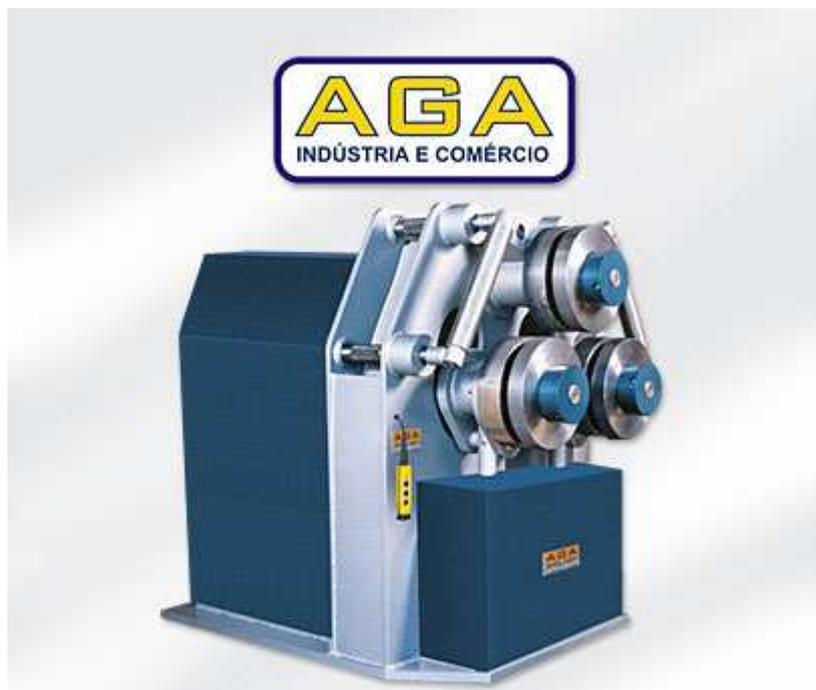
Figura 2.27 – Calandra de tubos e perfis hidráulica vertical. Fonte: AGAMAQ, 2008.
