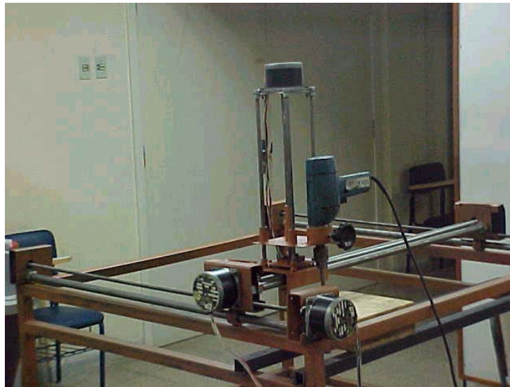
Figura 29. Foto do conjunto do equipamento de mesa de coordenadas para operações de furação.
