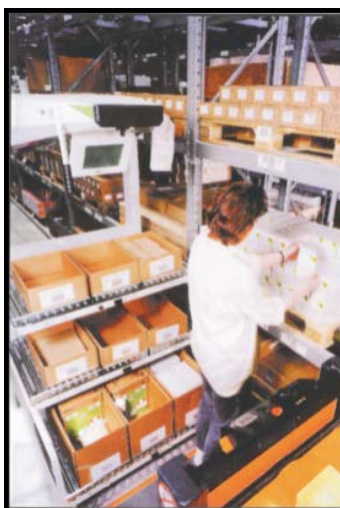
ILUSTRAÇÃO 6 - Acessório para facilitar a separação de pedidos é acoplado a uma empilhadeira selecionada de pedidos e ligado ao sistema de gerenciamento do armazém por rádio-freqüência.
