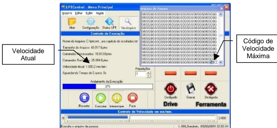
Figura 34 – Comando de Velocidade Máxima
