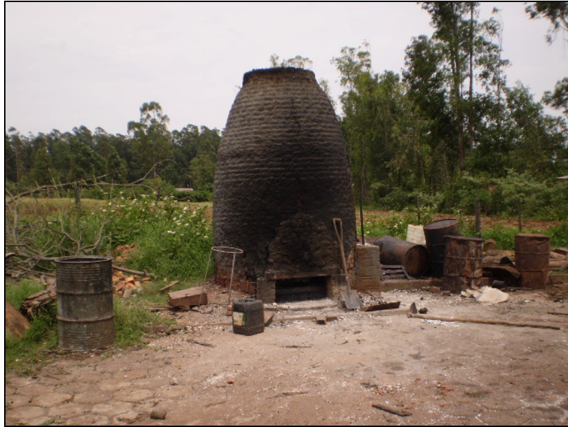
Figura 4.8 - Fornalha para desidratar o sangue
