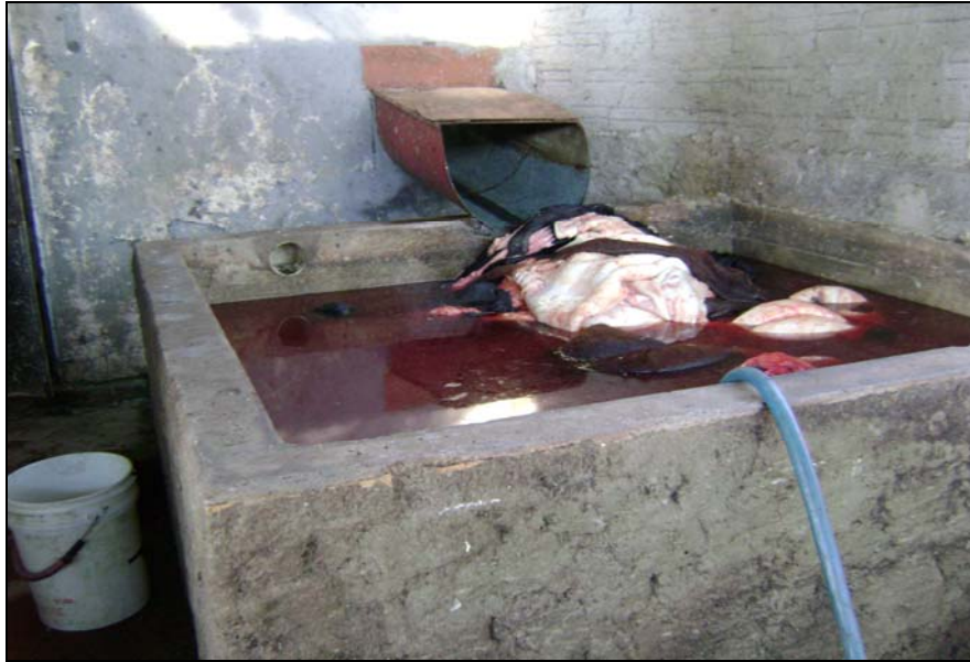
Figura 4.6 - Couros que durante o abate são removidos através de “chutes” e aguardam em água para serem transportados ao galpão.
