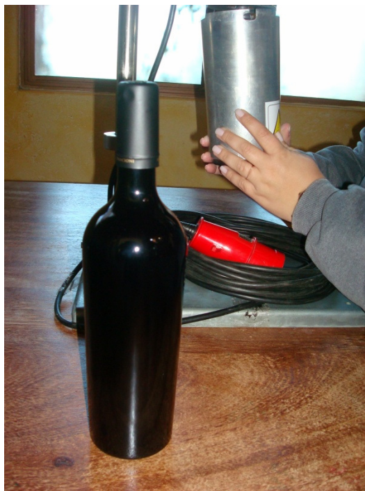
Figura 36 - Capsulagem das garrafas. Fonte: Autora
