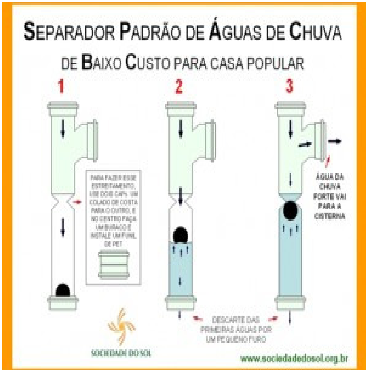
Figura 4.23 - Separador da primeira água de chuva de baixo custo
