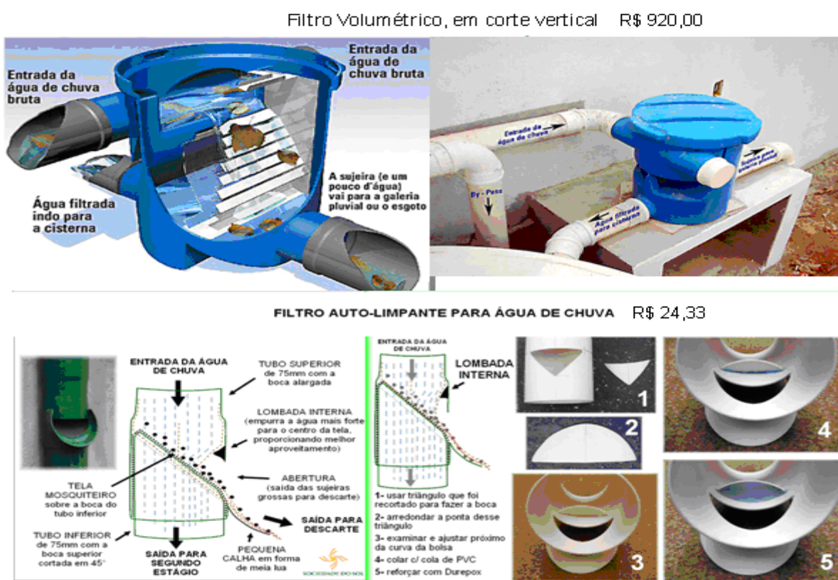
Figura 7.1 - Comparação dos modelos de Filtros Volumétricos e Auto limpante, ambos para grandes partículas.
