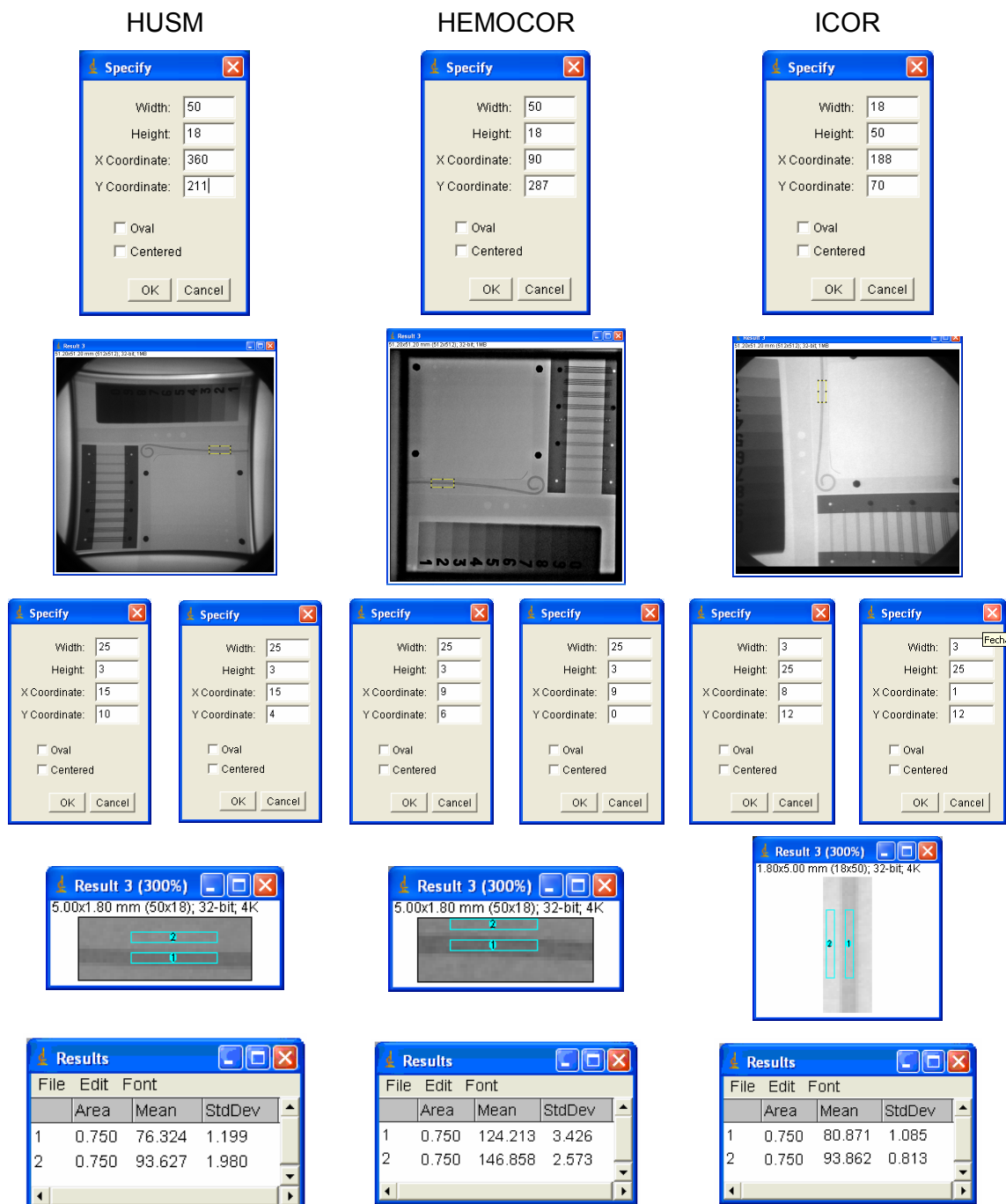
Figura 31 – ROI e análise das imagens do cateter nas imagens de referência dos três equipamentos de hemodinâmica.
