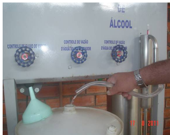
Foto 28 – O álcool saindo do equipamento para produção em batelada. Fonte: O autor.
