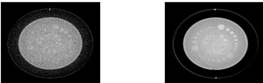
Figura 53 – “Phantoms” usados para avaliar a resolução de baixo contraste, exibido com diferentes filtros de reconstrução.
