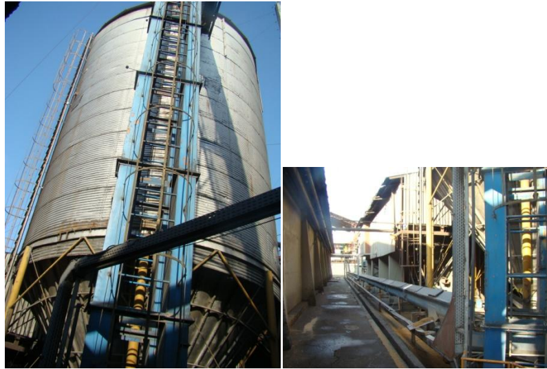
Figura 08: Silos de armazenagem da casca e esteiras transportadoras Fonte: Fotos reproduzidas com a autorização da Camil Alimentos S.A (2011)
