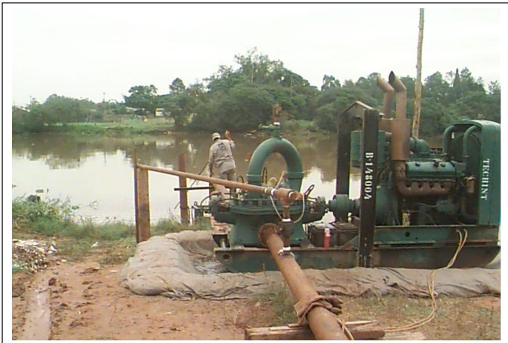
**FIGURA 09** - Estação de Bombeamento no Rio Caí, em Canoas/RS
