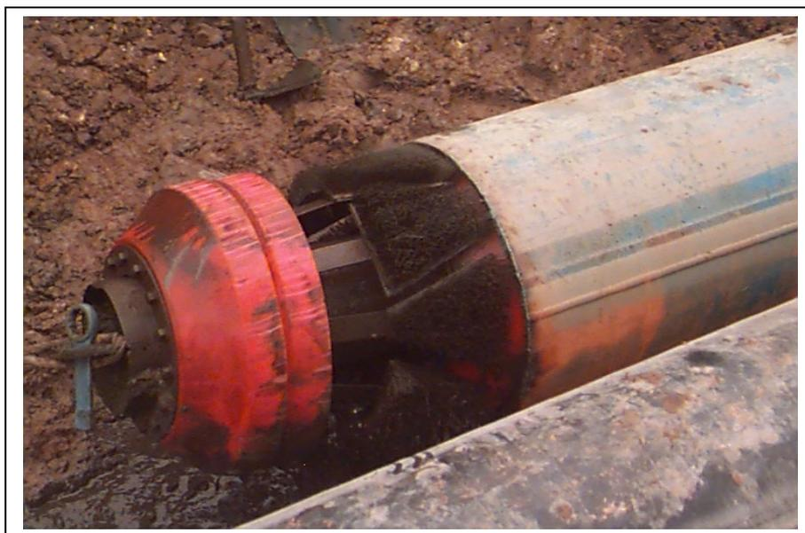
**FIGURA 05 - PIG tipo Escova sendo removido**
