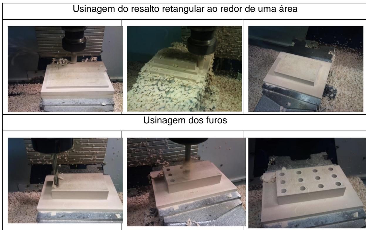
Figura 63 – Sequência de usinagem da peça teste 2
