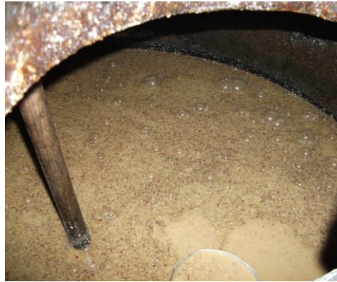
Figura 4.7 – Vista interna do tanque de hidrólise
