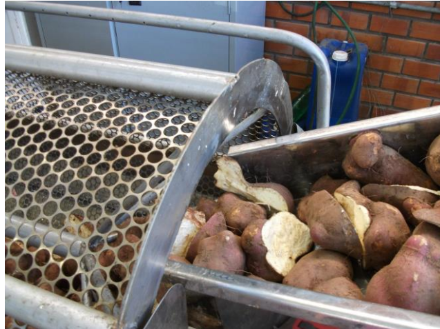
Figura 4.3 – Vista da alimentação da lavadora com tambor rotativo
