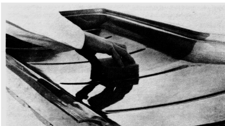
Aplicação de desmoldante à superfície do molde
