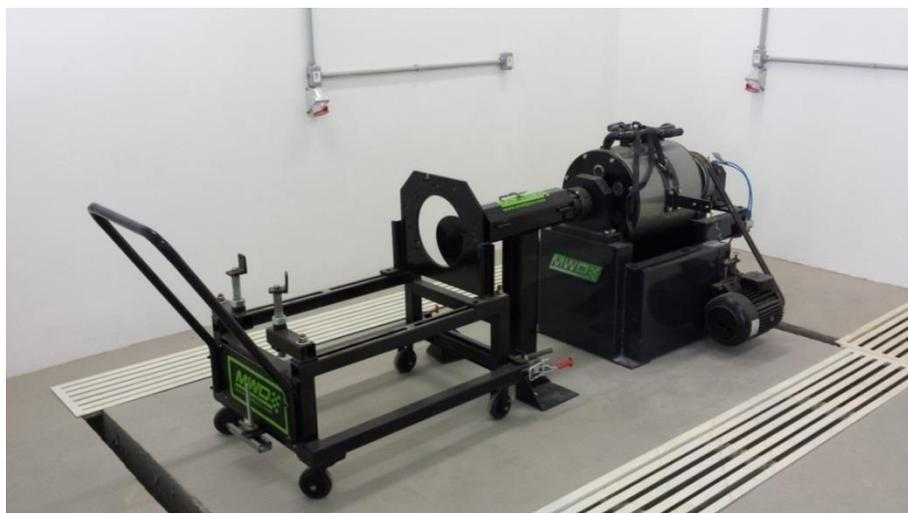
Figura 15 –Dinamômetro de correntes parasitas MWD modelo NL-260-E em fase de instalação
