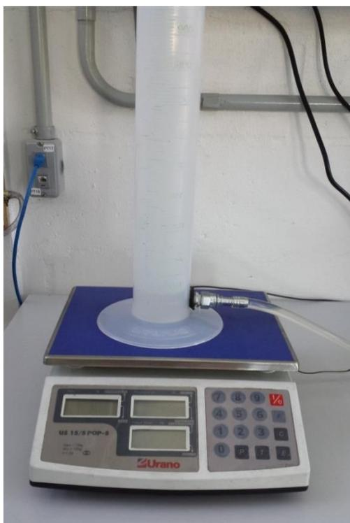
Figura 20 – Balança utilizada para mensuração do consumo de combustível
