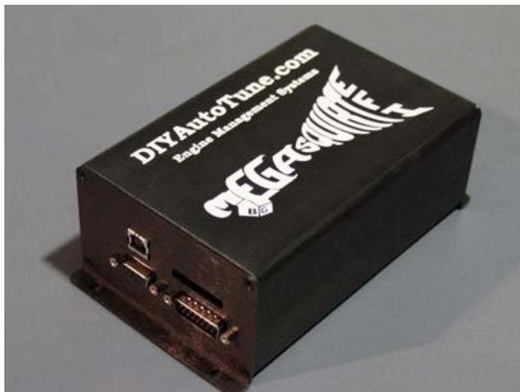
Figura 11 – Sistema de injeção MegaSquirt-III EFI
