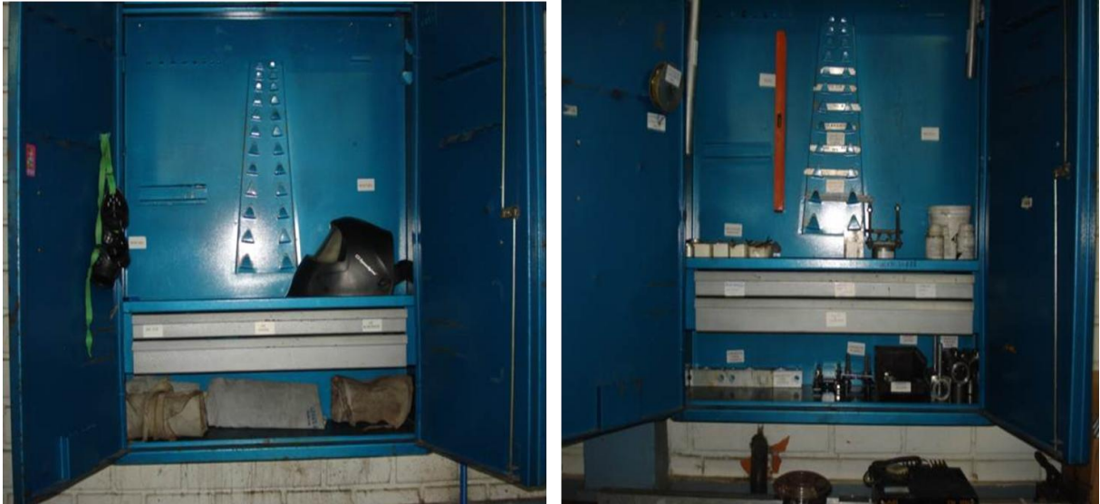
Figura 44: Antes e depois do armário de solda TIG com gabaritos identificados.
