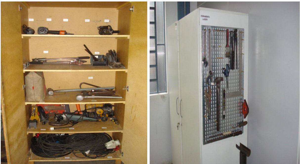
Figura 45: Armário de ferramentas gerais, organizado e identificado e painel de ferramentas do corte a laser.
