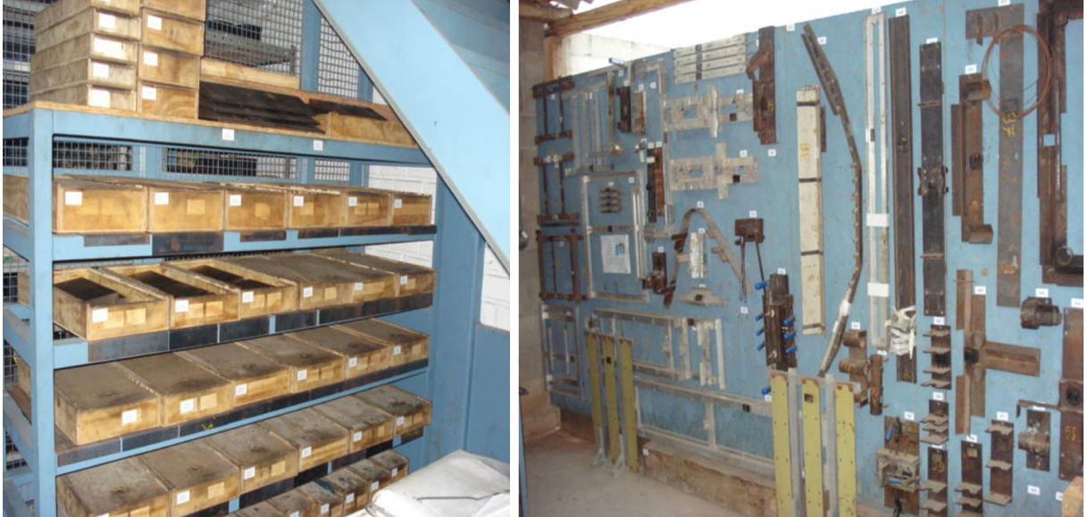
Figura 46: Ferramentas da dobradeira e gabaritos de solda organizados e identificados.
