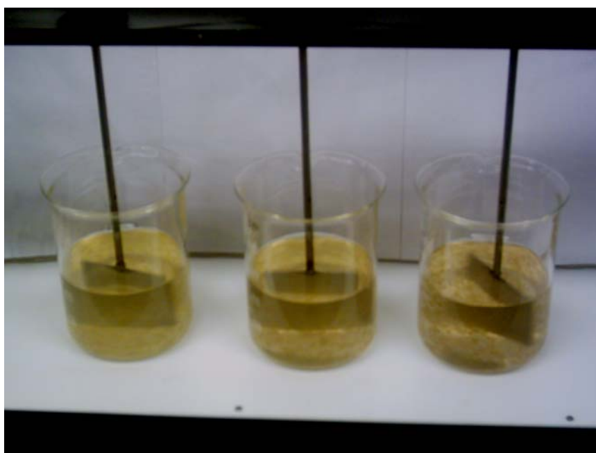
FIGURA 3 – Representação da cor da água no início do ensaio e a formação dos flocos do ensaio realizado, dia 16/03/05 às 14:00 hs, no laboratório da Tanac em Montenegro.
