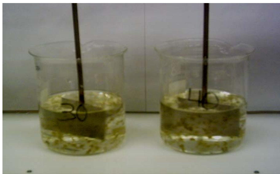
FIGURA 9 - Ensaio de floculação mostrando a ação do tanino na formação dos flocos em concentrações reduzidas, de 30 ppm e 40 ppm, realizado dia 16/03/05 às 16:00 hs, no laboratório da Tanac em Montenegro.
