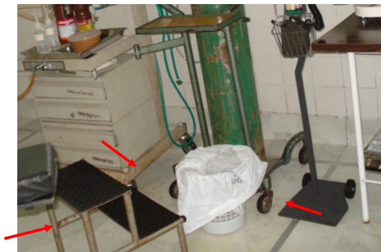
Figura 4.10 - Equipamentos em corrosão decorrente da ação do hipoclorito de sódio
