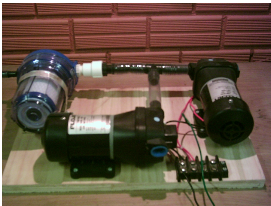
Figura 6.6 – Foto do sistema de injeção do ar de reação.
