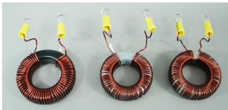
Figura 65 - Indutores Kool M \mu ®, MPP e HF para 30% @ 140 kHz
