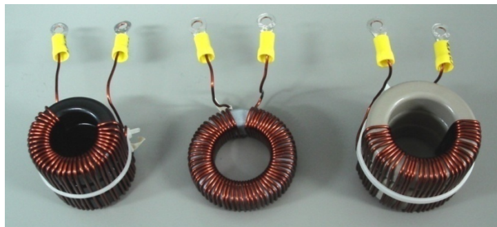
Figura 60 - Indutores Kool M \mu ®, MPP e HF para 80% @ 46,6 kHz.
