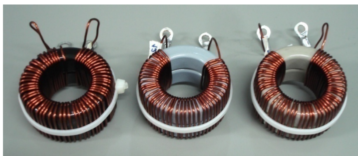
Figura 55 - Indutores Kool M \mu ®, MPP e HF para 40% @ 70 kHz.
