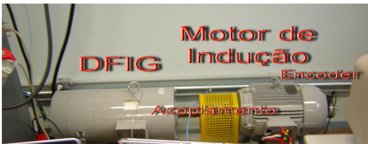
Figura 8-7 – Foto do conjunto Motor Gerador
