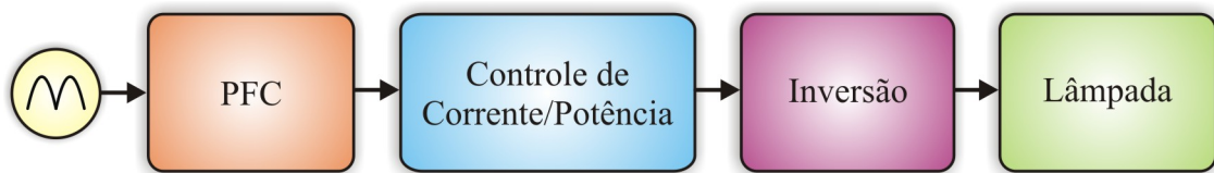
Figura 2: Diagrama de blocos das etapas de um reator eletrônico
