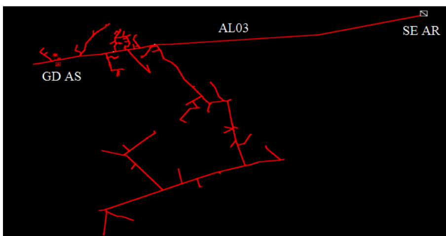
Figura 27 – Alimentador onde ocorrerá a conexão da GD a biogás de RSU.
