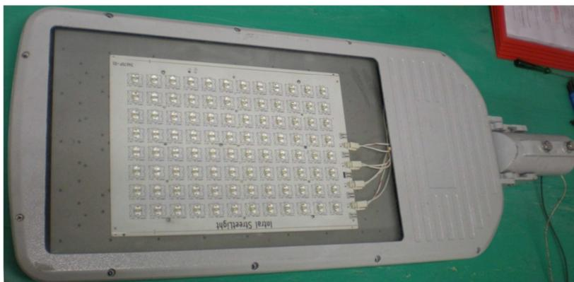
Figura 8.36 - Protótipo da luminária montada
