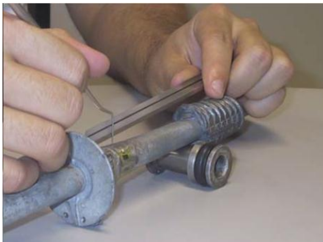
Figura 2.8 - Extensômetro instalado em um isolador Fonte: Penteado Neto (2005)
