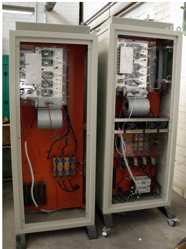
Figura 3.18 – Retificador e Inversor inseridos entre o gerador e a rede no NAFA/UFSM
