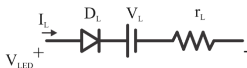
Figura 1.15 - Modelo elétrico linear para um LED.
