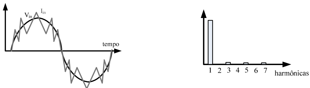
Figura 1-3: Tensão, corrente e conteúdo harmônico de uma carga não linear conectada à rede através de um Conversor Boost PFC.
