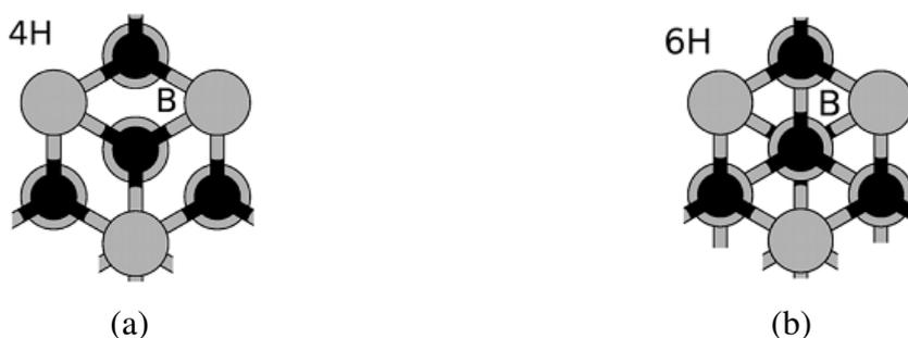
Figura 59 – Vista superior das estruturas cristalinas dos politipos SiC: (a) 4H-SiC; (b) 6H-SiC
