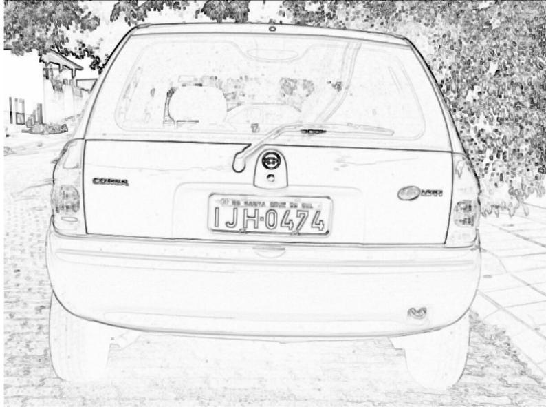
FIGURA 38 - Bordas da imagem obtidas a partir da análise do conteúdo armazenado em memória
