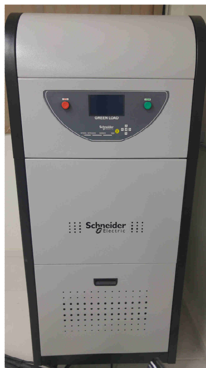
Figura 29 – Cargas resistivas: (a) Carga CA – Banco resistivo passivo, (b) Carga CA – Banco resistivo regenerativo
