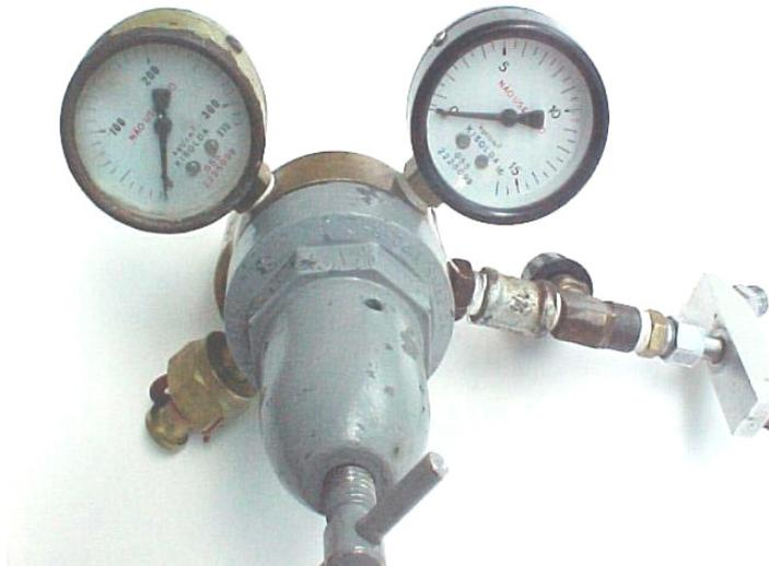
Figura 4.11 – Válvula redutora/reguladora de pressão usada para baixar e regular a pressão do gás natural
