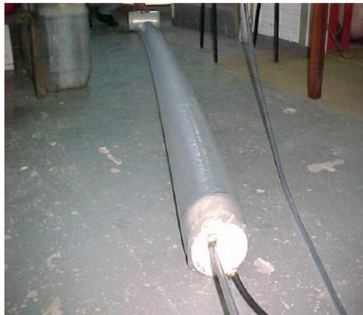
Figura 5.5 – Tubo inflado com gás, sendo medido, durante um teste de verificação de vazão do injetor
