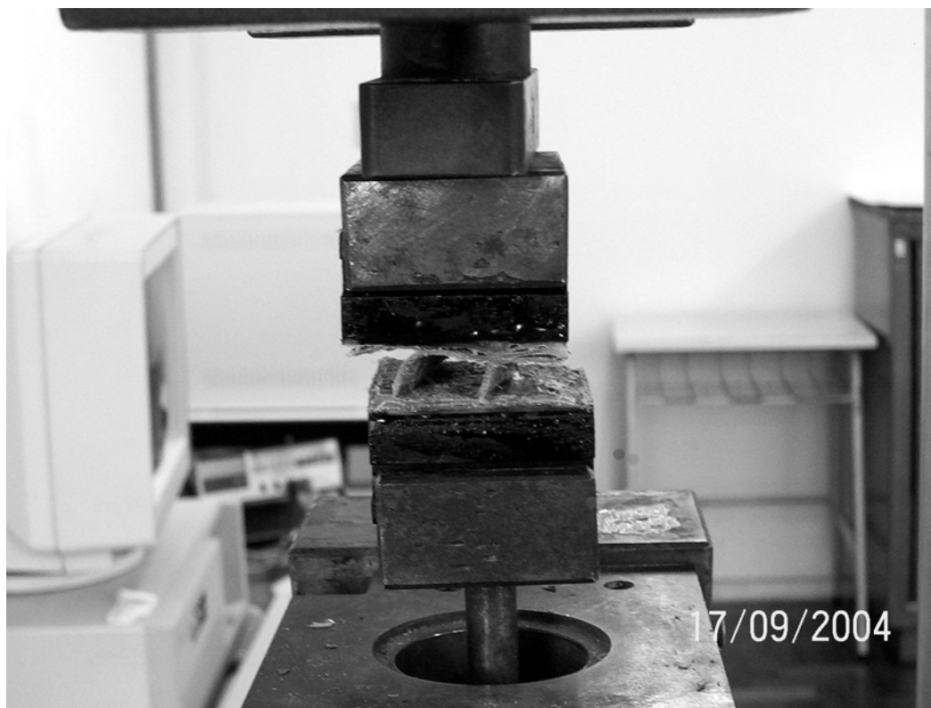
FIGURA 13: Visualização de um corpo de prova no momento da execução do teste de tração.
