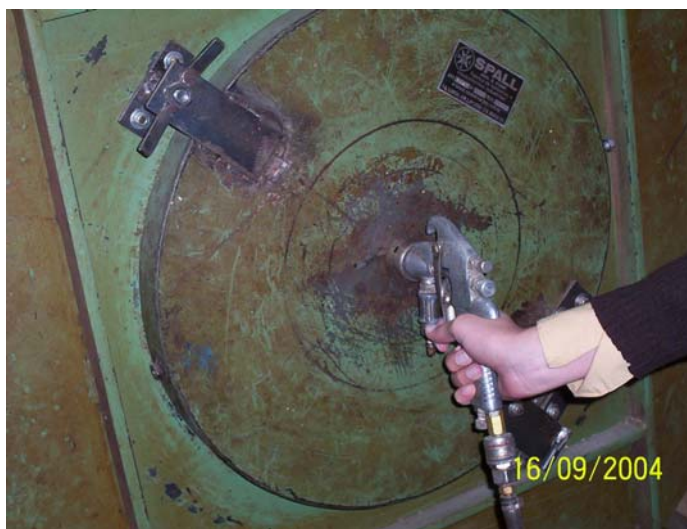
FIGURA 4. Aplicação do adesivo nas partículas com a pistola acionada por ar comprimido e acoplada ao tambor rotativo
